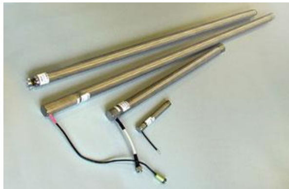
Рисунок 4 – Внешний вид детекторов нейтронов на основе гелий-3
