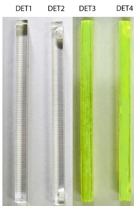
Рисунок 37 – Внешний вид световода после механической обработки
