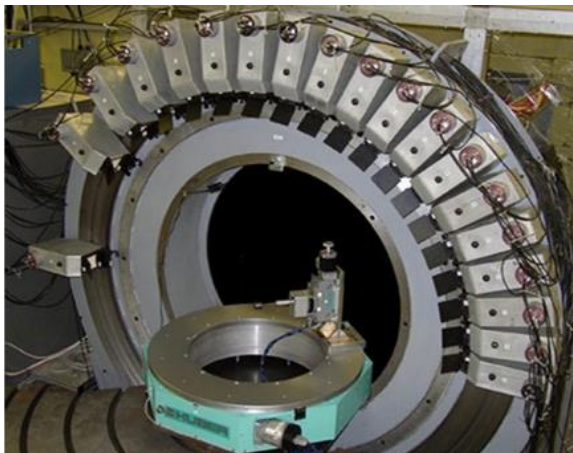
Рисунок 9 – Тектурный дифрактометр “СКАТ” исследовательского реактора ИБР-2м ОИЯИ
