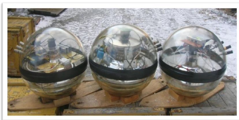
Рисунок 3-7 – прототипы ОМ на базе ФЭУ PHOTONIS XP1807 (слева), НАМАМАТСУ R8055 (в центре) и НАМАМАТСУ R7081HQE (справа)
