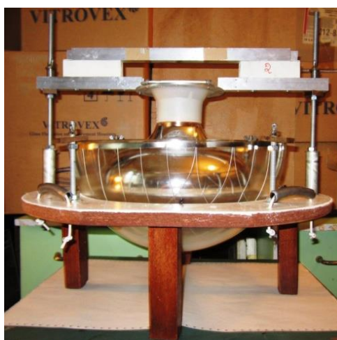
Рисунок 5-2 – монтажный стапель для вклейки ФЭУ и магнитного экрана на силиконовый гель
