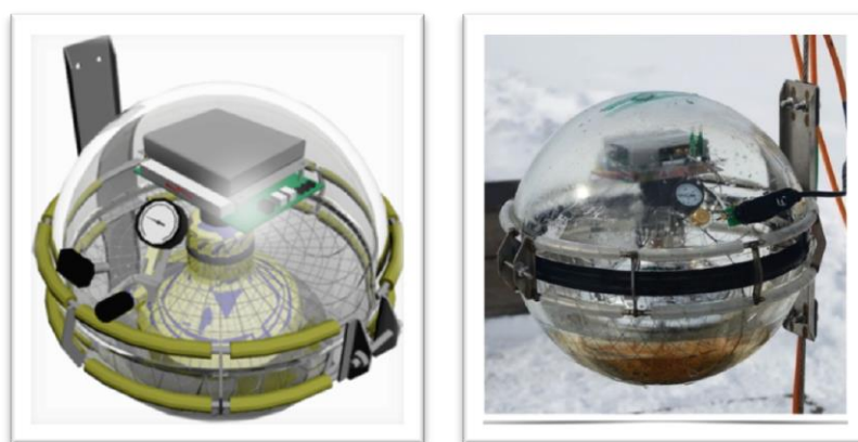
Рисунок 3-1 – модель оптического модуля (слева) и фотография оптического модуля смонтированного на гирлянде (справа)
