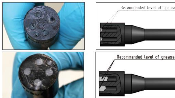
Рисунок 3-5 – схемы "сухого" (сверху) и "мокрого" (снизу) соединения разъёма
