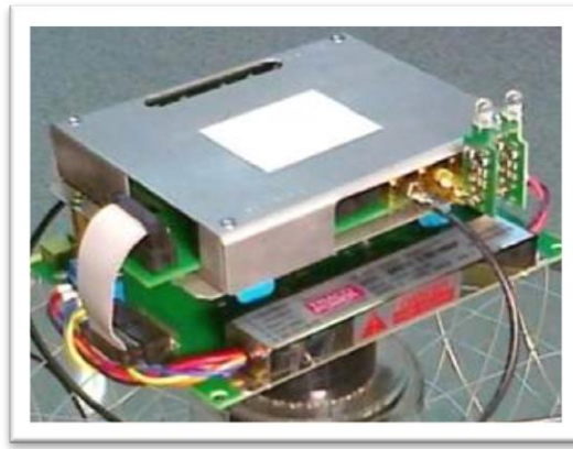
Рисунок 3-15 – блок электроники ОМ, установленный на цоколе ФЭУ
