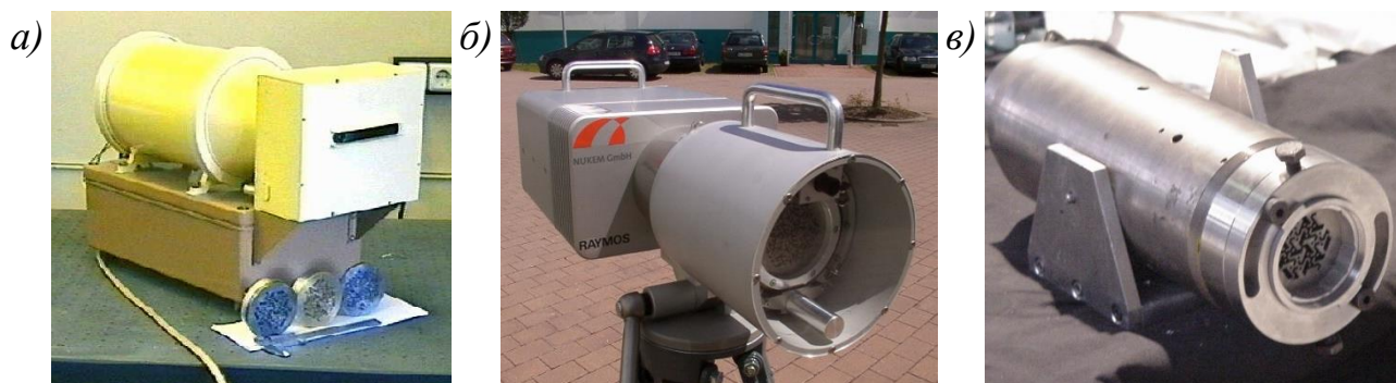
Рисунок 4 – Примеры гамма-камер [38]: SMGVC (КИ – SAIC) (а), RayMos (КИ – NUKEM) (б), Cartogam (КИ – CEA) (в)
