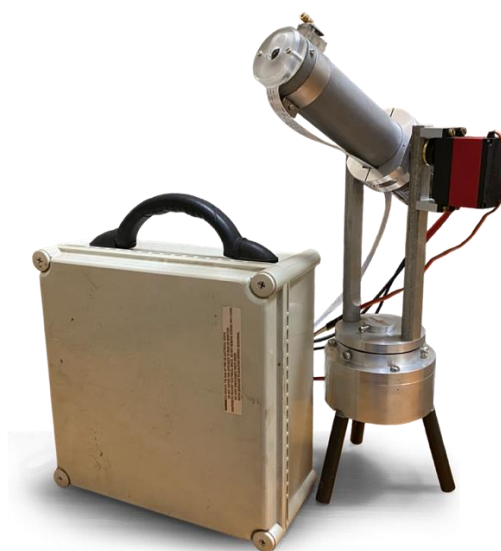
Рисунок 65 – Фото внешнего вида гамма-сканера с антиколлиматором
