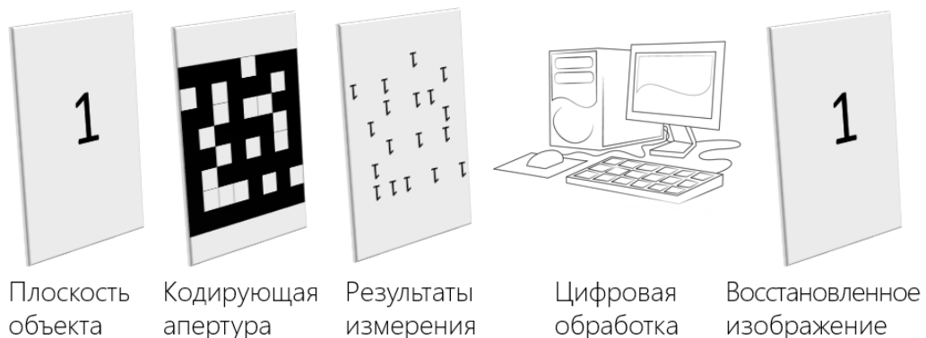
Рисунок 14 – Последовательность процедур при восстановлении изображения, полученного с помощью кодирующей апертуры
