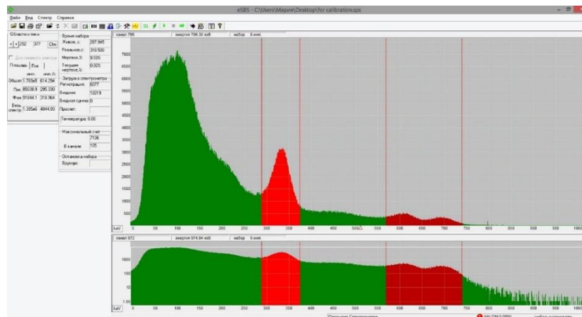
Рисунок 86 – Спектр радионуклидов ^{137}\text{Cs} и ^{60}\text{Co}
