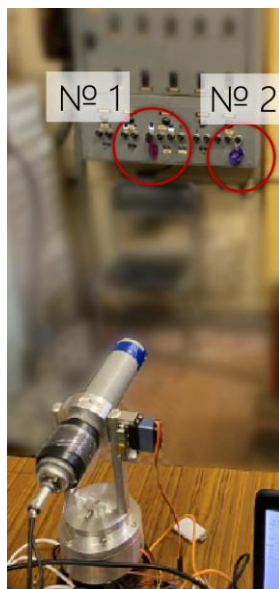
Рисунок 88 – Фото эксперимента по определению углового разрешения гамма-сканера с антиколлиматором
