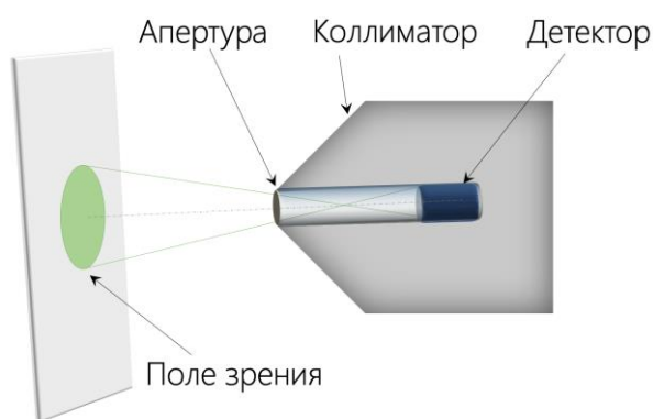
Рисунок 8 – Схема сканирующего устройства с коллиматором
