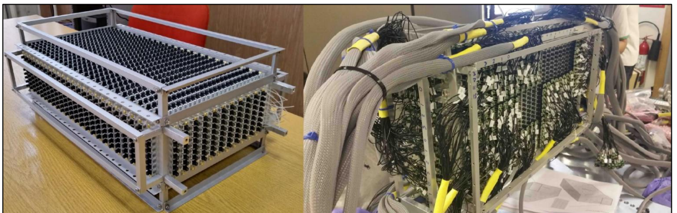
Рис. 20 Фотографии второго прототипа детектора SuperFGD.
