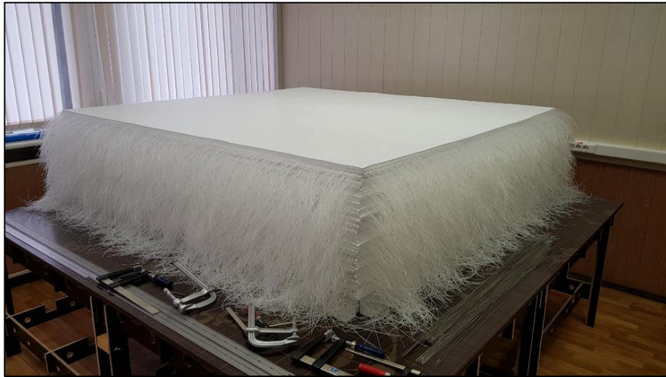
Рис. 38 Собранные на лесках 49 плоскостей (192 × 184 кубика) детектора SuperFGD.
